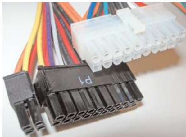
Slika 3: Izgled ATX 24-pinskog i 20-pinskog glavnog konektora
