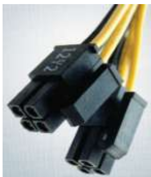
Slika 9: Izgled 4-pinskog +12V CPU konektora (levo) i raspored pinova i napona na konektoru (desno)
